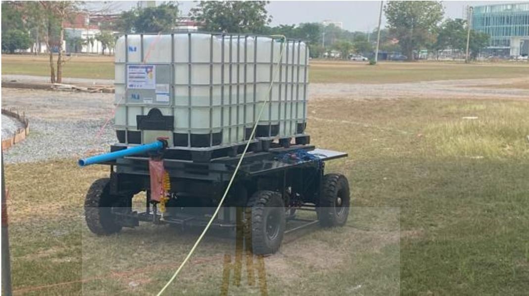
รูปที่ 5.58 การทดสอบอ่านค่าน้ำหนักด้วยโหลดเซลล์ของถังน้ำจำนวน 2 ถัง เติมน้ำถังละ 500 L
