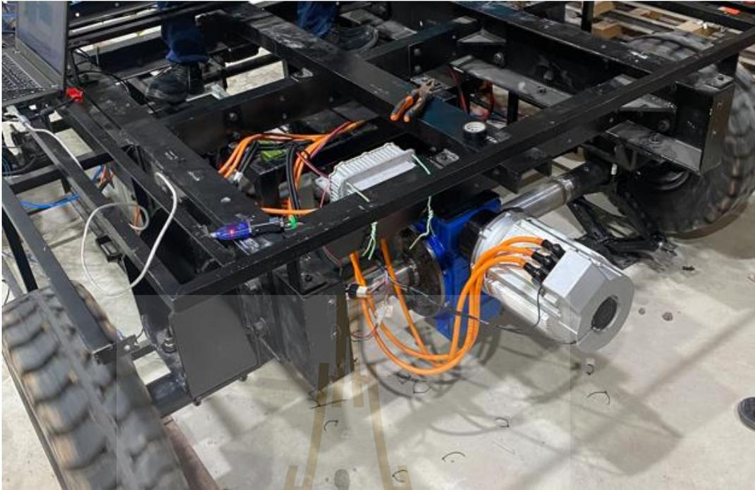
รูปที่ 5.2 การพัฒนาโครงสร้างในส่วนระบบขับเคลื่อน
