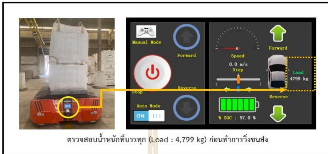
รูปที่ 5.124 ผลการทดสอบตรวจสอบน้ำหนักที่บรรทุก (Load : 4,799 kg) ก่อนทำการวิ่งขนส่ง
