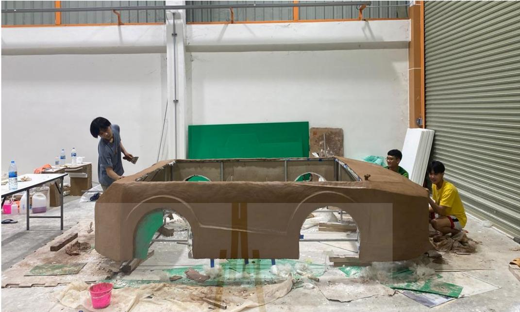
รูปที่ 5.4 การปั้นดินเหนียวที่ใช้เป็นแบบในการหล่อโมล
