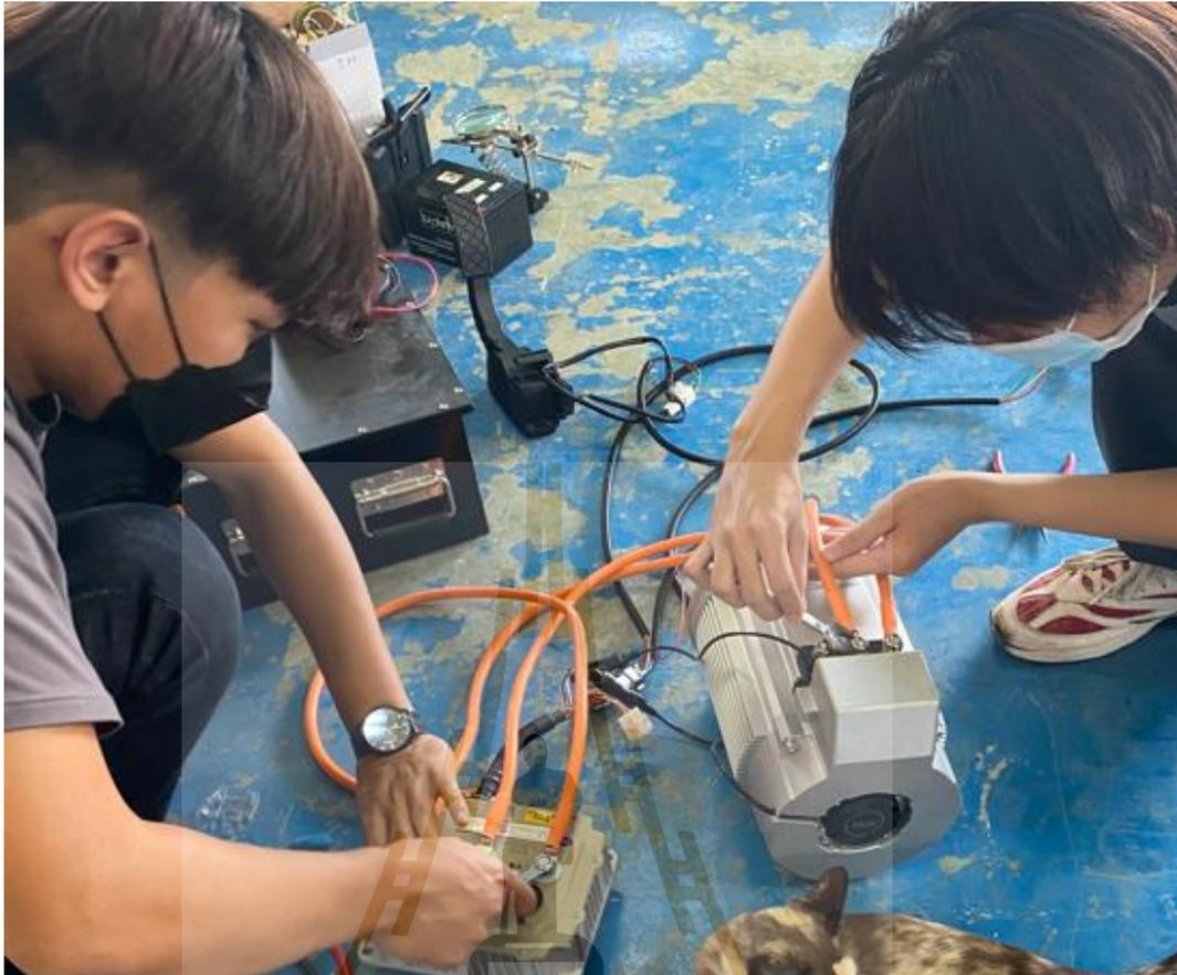
รูปที่ 5.15 การเชื่อมต่อสายไฟจากแบตเตอรี่ไปยังชุดควบคุมมอเตอร์และมอเตอร์ไฟฟ้า
