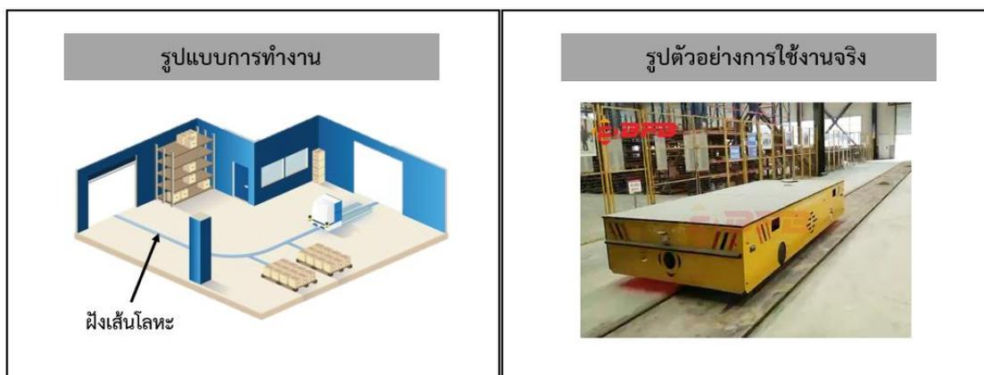
รูปที่ 3.34 ตัวอย่างระบบใช้งานการนำทางด้วยแม่เหล็กไฟฟ้า
