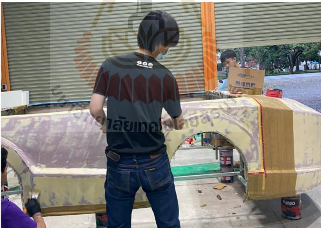
รูปที่ 5.5 การโป้วสีและขัดผิวที่ใช้เป็นแบบในการหล่อโมล
