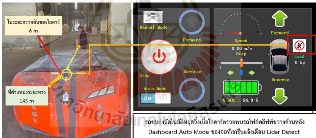
รูปที่ 5.137 ผลการทดสอบรถขนส่งอัตโนมัติหยุดวิ่งเมื่อไลดาร์ตรวจพบว่ามีสิ่งกีดขวางในระยะ 6 m
