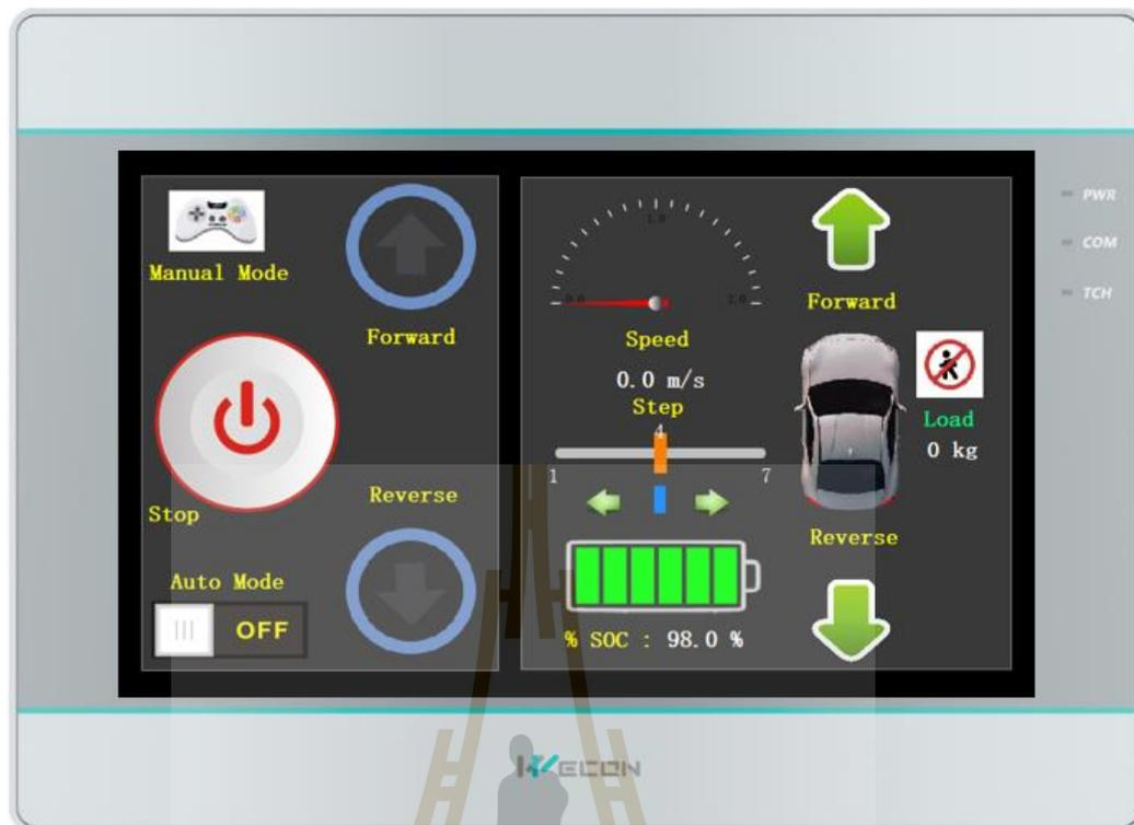
รูปที่ 4.46 Dashboard จอทัสกรีนควบคุมการทำงานของรถขนส่งอัตโนมัติ
