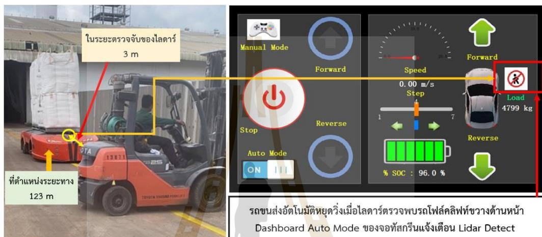
รูปที่ 5.126 ผลการทดสอบรถขนส่งอัตโนมัติหยุดวิ่งเมื่อไลดาร์ตรวจพบว่ามีสิ่งกีดขวางในระยะ 3 m
