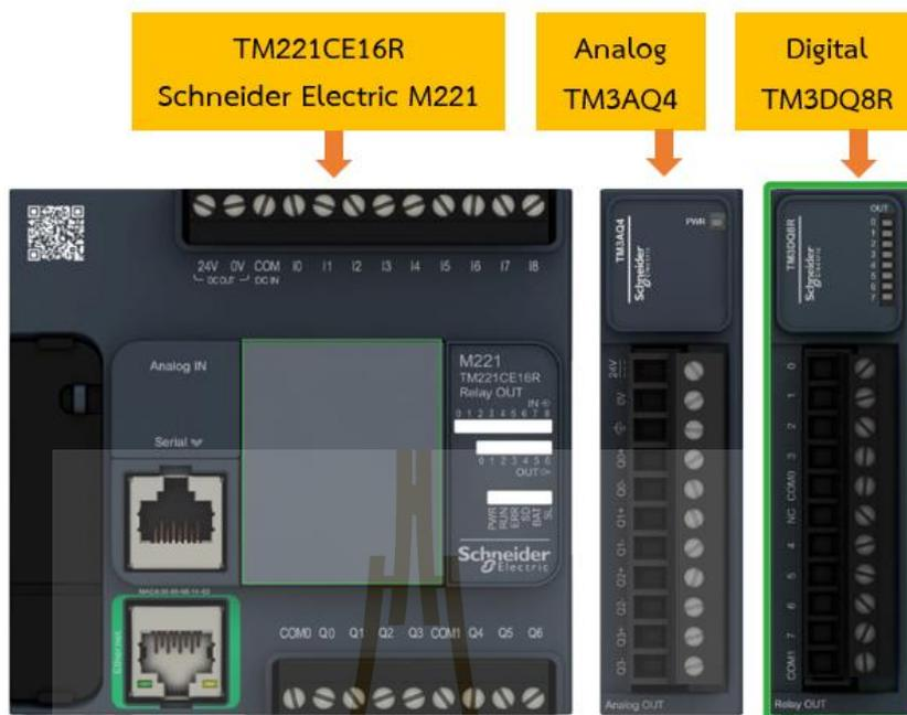
รูปที่ 4.36 พีแอลซี TM221CE16R Schneider Electric M221
