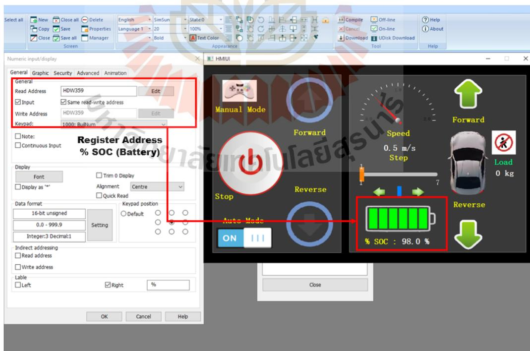
รูปที่ 5.104 กำหนด Register Address พารามิเตอร์ % SOC ที่ Dashboard Auto Mode
