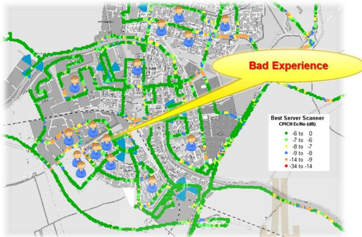
รูปที่ 3.1 ผู้ใช้งานได้รับบริการที่ไม่ดีแม้ความแรงของสัญญาณ โดยรอบอยู่ในระดับที่ดี
