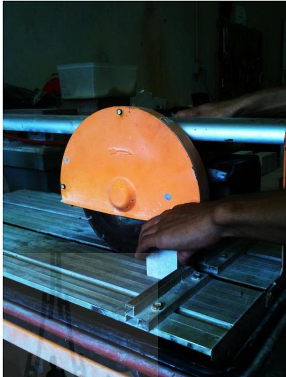
รูปที่ 5.2 เครื่องตัดหินทราย Model ZE-LG3-570A tile cutter (บน) และตัวอย่างหินทราย
