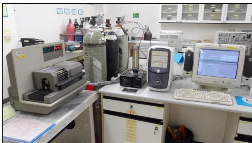
รูปที่ 4.8 เครื่อง Simultaneous TGA-DTA analyzer (SDT 2960, TA Instrument)
