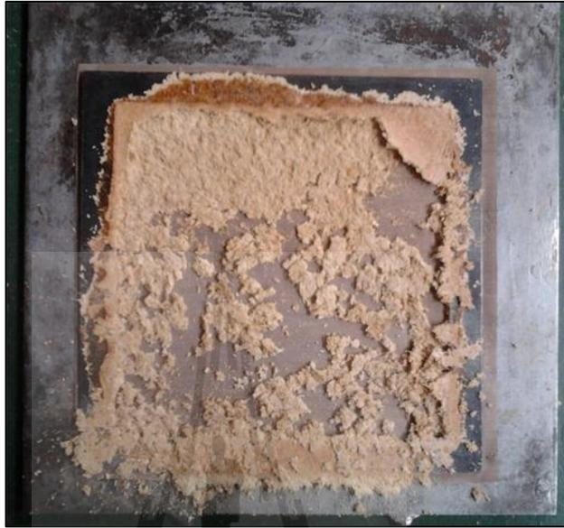
รูปที่ 5.2 ตัวอย่างลักษณะของชิ้นงานที่ได้จากกระบวนการอัดขึ้นรูปที่อุณหภูมิสูง และเวลาน้อยเกินไป
