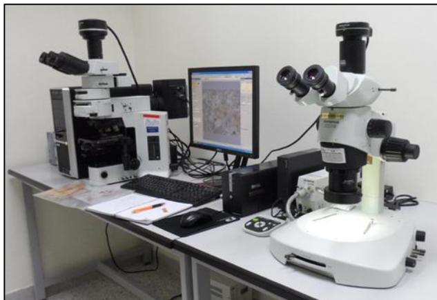
รูปที่ 4.7 กล้องจุลทรรศน์แบบใช้แสงชนิดสเตอริโอ (OLYMPUS, model SZX16-DP21)
