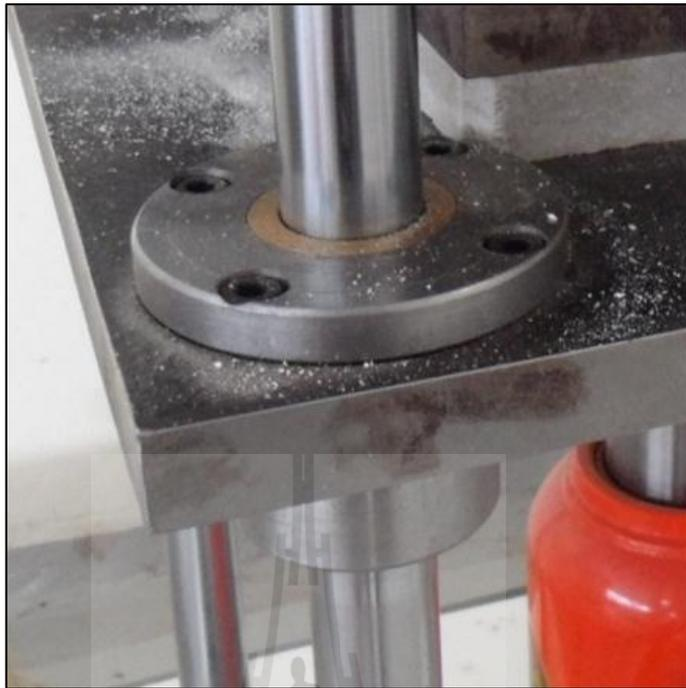
รูปที่ 3.3 ปลอกทองเหลืองติดตั้งเข้ากับแท่นรองแม่พิมพ์ตัวล่าง
