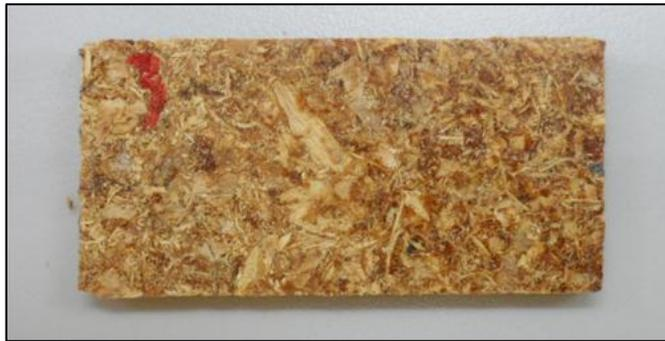
รูปที่ 4.5 ตัวอย่างลักษณะของชิ้นทดสอบสมบัติการดูดซึมน้ำ
