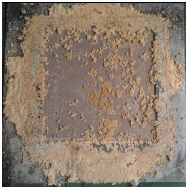
รูปที่ 5.4 ตัวอย่างลักษณะของชิ้นงานที่ได้จากกระบวนการอัดขึ้นรูป
