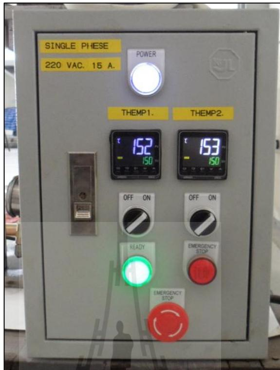
รูปที่ 3.6 ตู้ควบคุมระบบไฟฟ้าของเครื่องอัดขึ้นรูปร้อนในงานวิจัย
