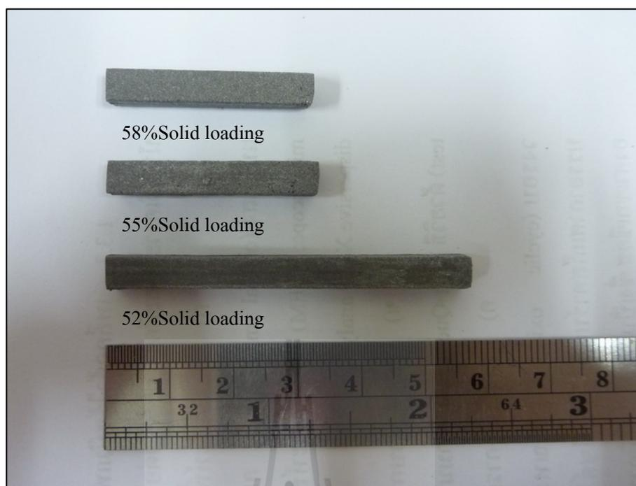
รูปที่ 4.8 ชิ้นงานหลังการฉีดขึ้นรูป (Green samples)
