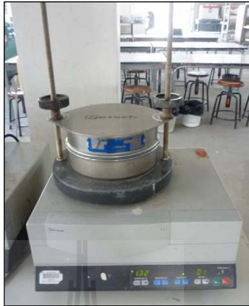
รูปที่ 3.11 การแยกผงวัสดุออกจากลูกบดเซอร์โคเนีย
