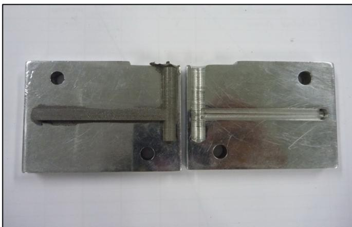
รูปที่ 3.16 ชิ้นงานที่ผ่านการฉีดขึ้นรูป
