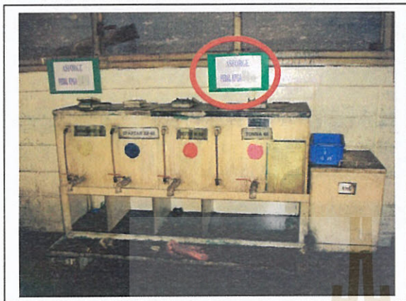
รูปที่ 2.6 แสดงถึงสารองน้ำมันหล่อลื่น เครื่องจักร มีป้ายชื่อชิ้นงานติดอยู่
