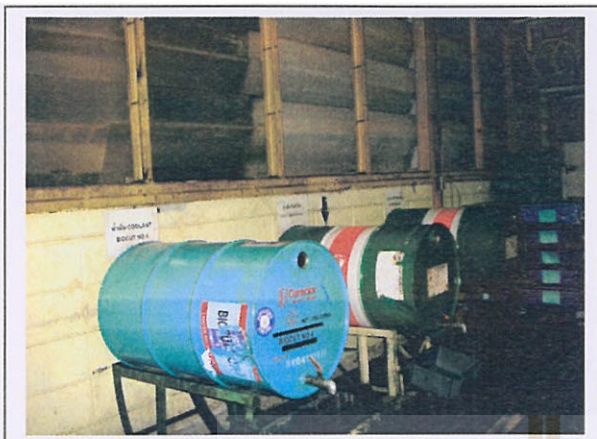
รูปที่ 2.9 แสดงถังน้ำมันรอใช้งาน มีป้าย ข้อมูลเคมีอยู่แต่ไม่มี MSDS
