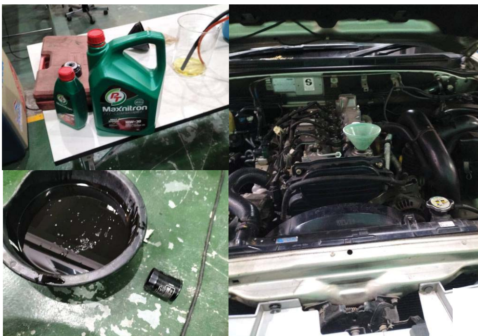
รูปที่ ข.4 การเปลี่ยนถ่ายน้ำมันเครื่อง
