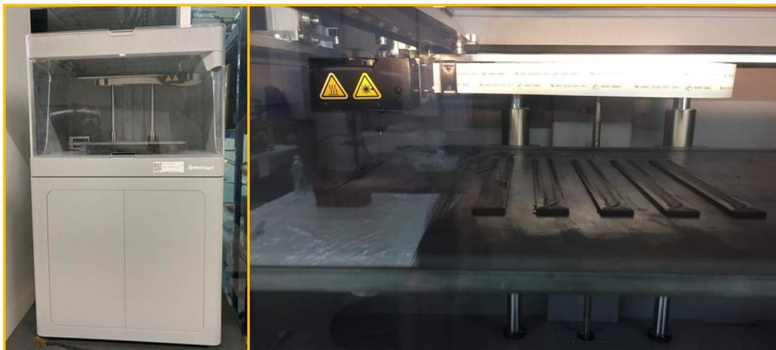
รูปที่ 3.7 ภาพแสดงเครื่องพิมพ์วัสดุคอมโพสิตแบบสามมิติ Markforged รุ่น X7 (ซ้าย) และขณะเครื่องพิมพ์กำลังพิมพ์ชิ้นงานทดสอบ (ขวา)
