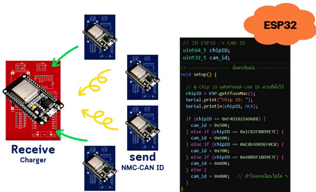
รูปที่ 3.6 การรับและส่ง CAN ID ระหว่างกล่องแบตเตอรี่ NMC และตู้ชาร์จผ่าน CANopen
