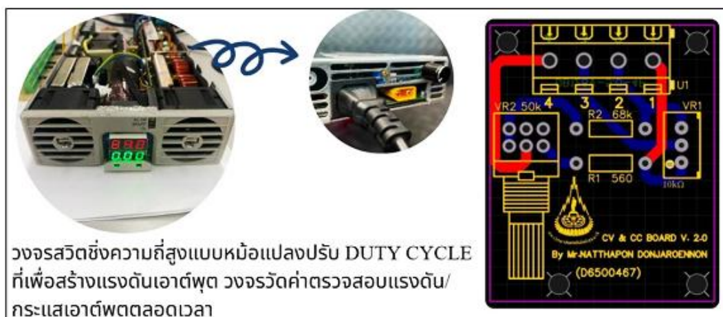
รูปที่ 3.4 วงจรควบคุมแรงดันและกระแสของเครื่องชาร์จแบบฟิกส์ CC-CV
