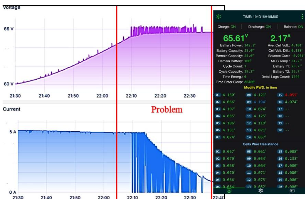
รูปที่ 4.16 พฤติกรรมการ Balancing ของแบตเตอรี่และข้อมูลแรงดันรายเซลล์จากระบบ BMS
