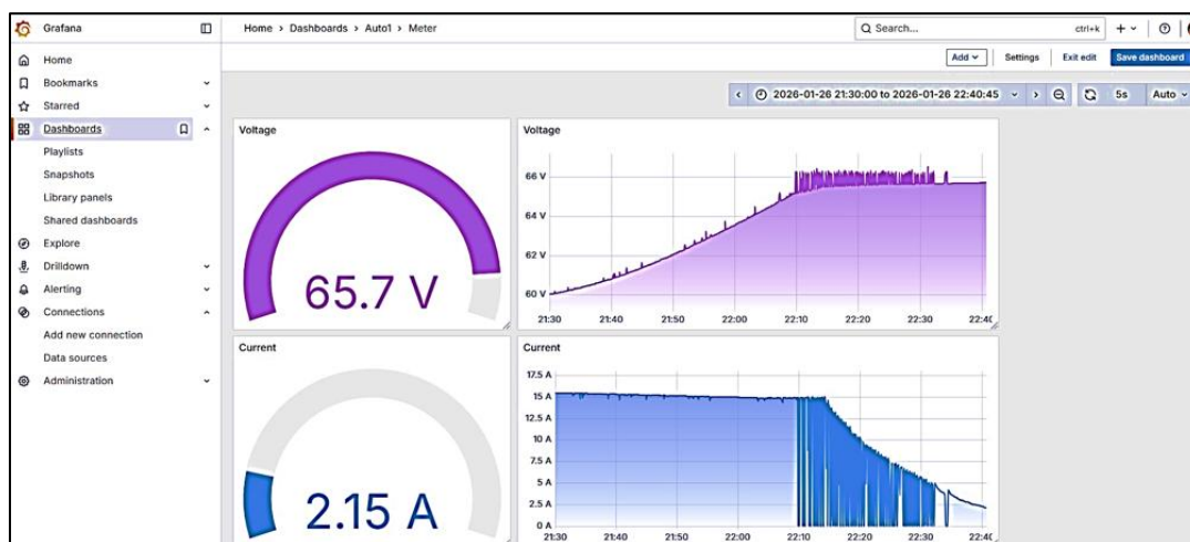
รูปที่ 4.15 พฤติกรรมกระแสไฟฟ้าที่ไม่ต่อเนื่องระหว่างการชาร์จแบตเตอรี่โปรไฟล์ 60V 5A
