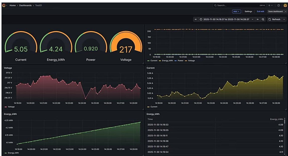
รูปที่ 4.5 การแสดงผลข้อมูลพลังงานไฟฟ้าฝั่ง AC ผ่าน Grafana Dashboard ของระบบ 72V 15A
