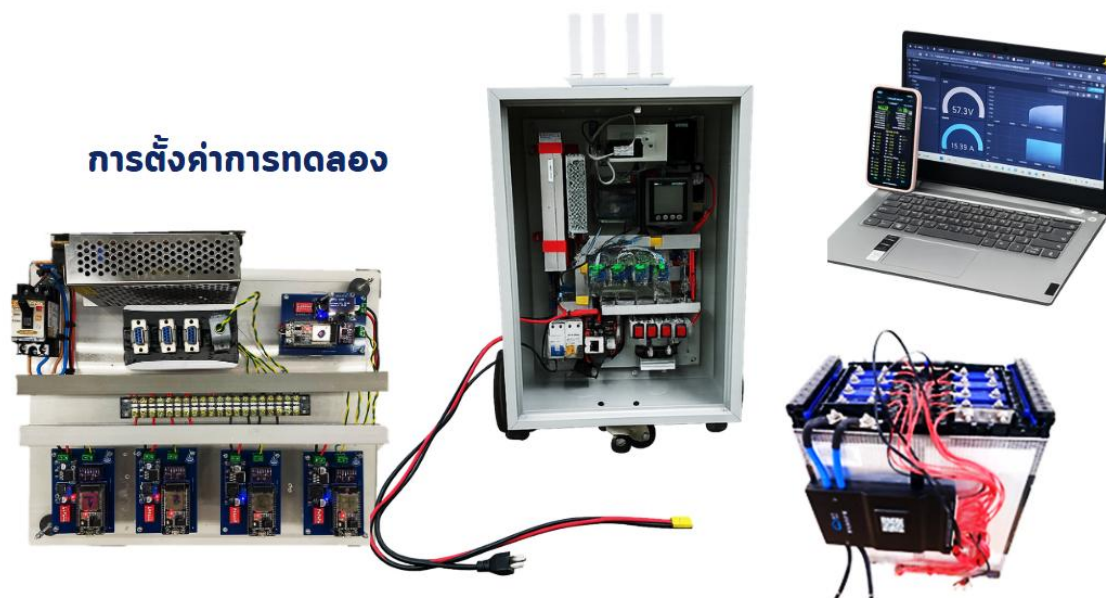
รูปที่ 4.1 การตั้งค่าการทดลองของระบบชาร์จแบตเตอรี่ NMC แรงดันต่ำ
