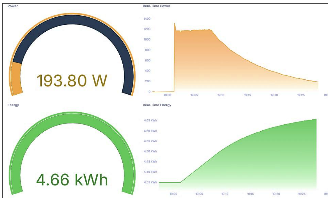
รูปที่ 4.8 กราฟกำลังไฟฟ้าและพลังงานไฟฟ้าในการชาร์จแบตเตอรี่ 72V 15A แสดงผ่าน Grafana
