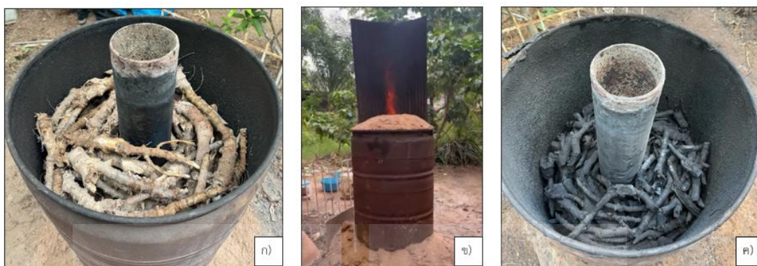
รูปที่ 3.3 กระบวนการผลิตถ่านหุง้ำมันสำปะหลัง ก) การคัดเลือกหุง้ำมันสำปะหลัง ข) กระบวนการไพโรไลซิส และ ค) ถ่านหุง้ำมันสำปะหลัง
