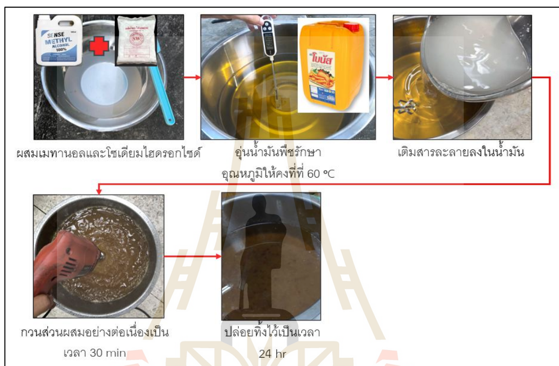
รูปที่ 3.5 กระบวนการทำปฏิกิริยาทรานส์เอสเทอริฟิเคชัน
