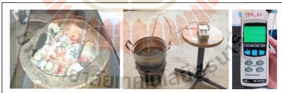
รูปที่ 2.15 การทดลองโดยใช้ถ่านอัดแท่งให้ความร้อนต่อน้ำ (Auntaisong & Maneechot, 2019)
