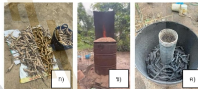
รูปที่ 1 ก) ตัดเลือกเหง้ามันสำปะหลัง, ข) กระบวนการไพโรไลซิส และ ค) หลัจากกระบวนการไพโรไลซิส
