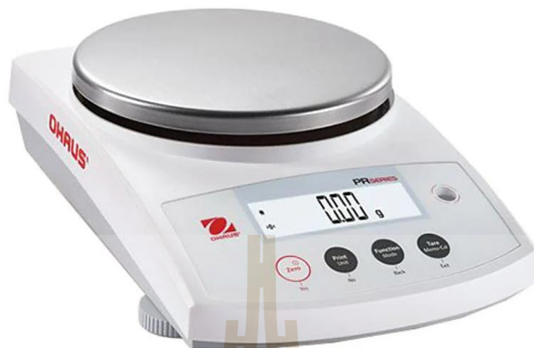
รูปที่ 3.7 เครื่องชั่งมวลของชิ้นงานตัวอย่างความละเอียดทศนิยม 2 ตำแหน่ง
