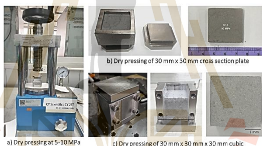
Fig. 4 Dry pressing of FB-1 to FB-4 formulas.
