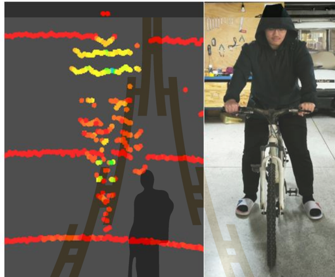
รูปที่ 3.9 ภาพกลุ่มพอยคลาวด์ของคนขี่จักรยานจากเซนเซอร์ LiDAR และภาพคนขี่จักรยานจากกล้อง
