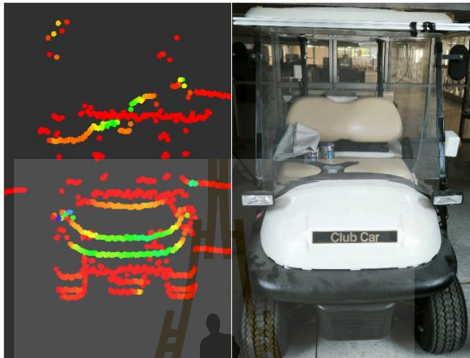
รูปที่ 3.10 ภาพกลุ่มพอยคลาวด์ของรถจากเซนเซอร์ LiDAR และภาพรถจากกล้อง
