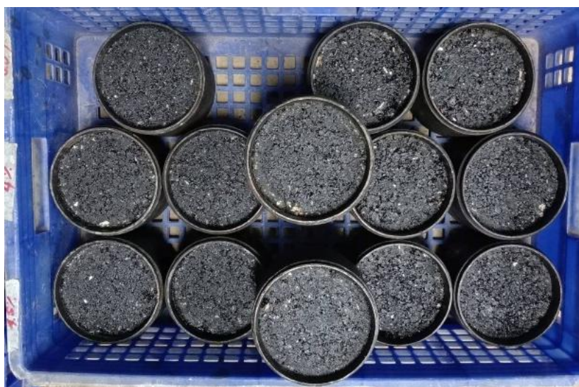
รูปที่ 3.11 ก้อนตัวอย่างแอสฟัลต์คอนกรีตที่ผลิตเสร็จรอทดสอบ
