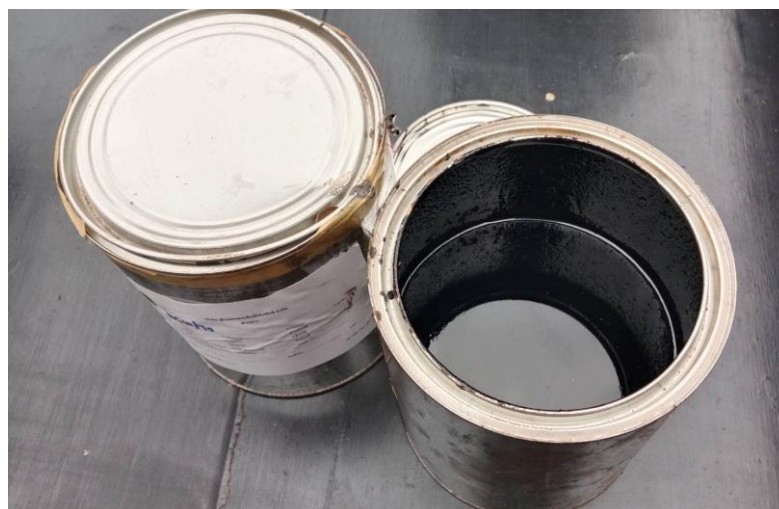
รูปที่ 3.3 แอสฟัลต์ซีเมนต์ AC 60/70 ที่ใช้ในงานวิจัย
