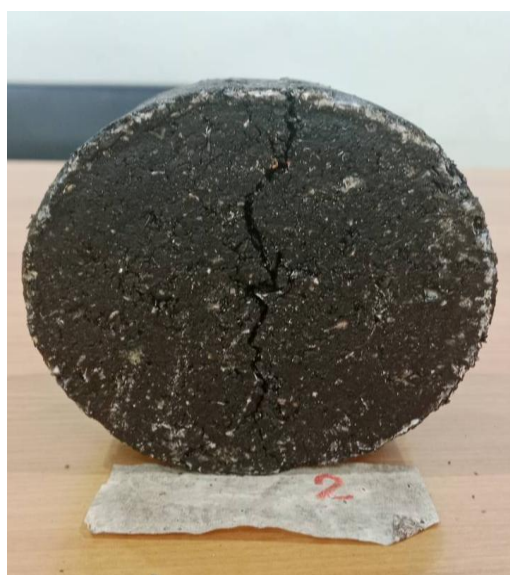
รูปที่ 3.17 ความเสียหายของก้อนตัวอย่างหลังการทดสอบการล้าเนื่องจากแรงดึงทางอ้อม
