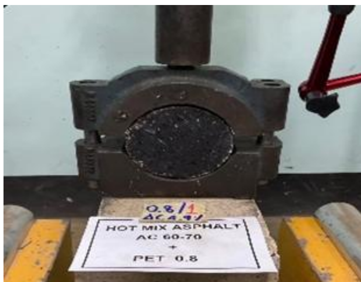
รูปที่ 3.13 การทดสอบเสถียรภาพและการไหลของแอสฟัลต์คอนกรีต
