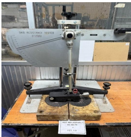
รูปที่ 3.20 เครื่อง British pendulum tester
