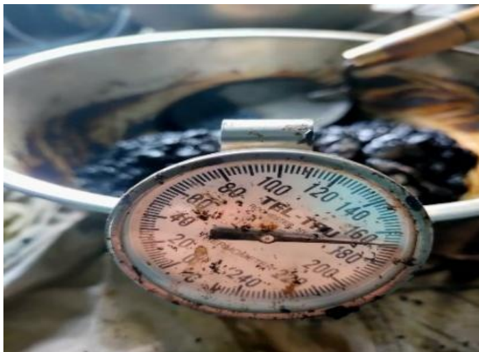
รูปที่ 3.8 การควบคุมอุณหภูมิขณะผสมแอสฟัลต์คอนกรีต
