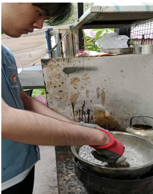
รูปที่ 3.9 การผสมแอสฟัลต์คอนกรีต
