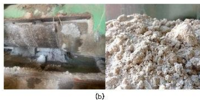
รูปที่ 4 (a) ขวดพลาสติก PET รอการรีไซเคิล (b) วัสดุเศษขยะพลาสติก PET ที่เหลือทิ้งจากขบวนการรีไซเคิล
