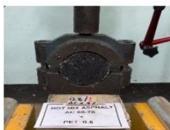
รูปที่ 7 การทดสอบแอสฟัลต์คอนกรีต โดยวิธีมาร์แชล (Marshall)
