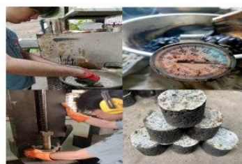
รูปที่ 6 การผลิตก้อนตัวอย่างแอสฟัลต์คอนกรีต
