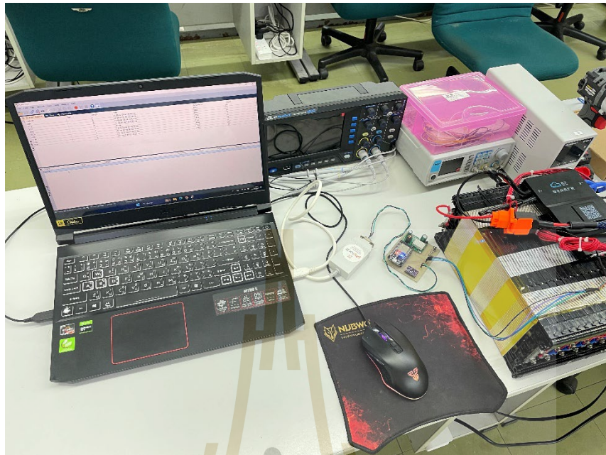
รูปที่ 3.3 การเชื่อมต่อวงจรทดสอบระหว่างระบบจัดการแบตเตอรี่ กับโปรแกรม PCAN-View
