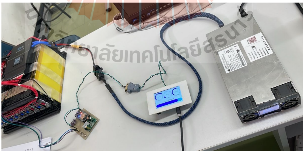
รูปที่ 4.5 การตั้งค่าระบบระหว่างการทดสอบการชาร์จเร็ว
