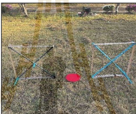
รูปที่ 4.7 สายอากาศแถวลำดับแบบปวงขนาดเล็ก 1x2 อีลิเมนต์
