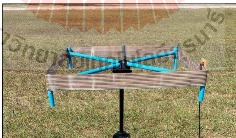
รูปที่ 4.1 สายอากาศต้นแบบแบบบ่วงขนาดเล็ก
