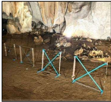
(ก) การจัดวางสายอากาศแถวลำดับ 1x4
