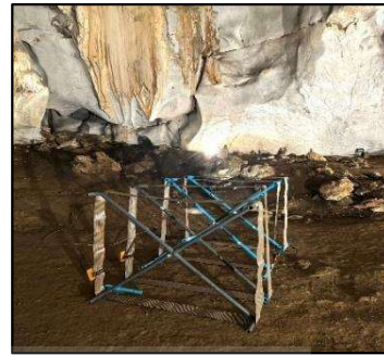
(ข) การจัดวางสายอากาศแถวลำดับ 4x1
