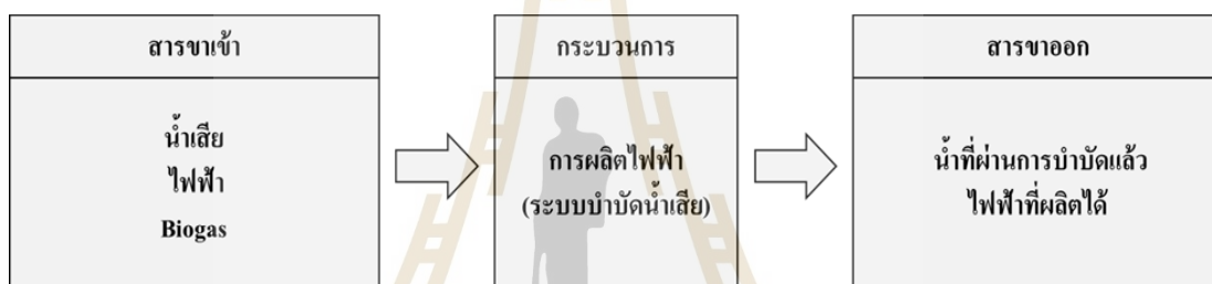
รูปที่ 3.11 ผังสารขาเข้าและสารขาออกของการผลิตไฟฟ้า (บำบัดน้ำเสีย)
