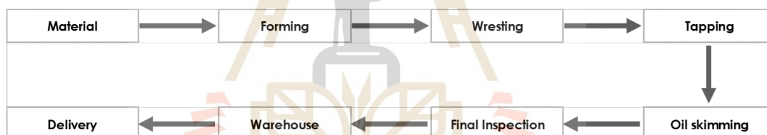
รูปที่ 3.2 ขั้นตอนการผลิตชิ้นส่วนน็อต (Nuts)
