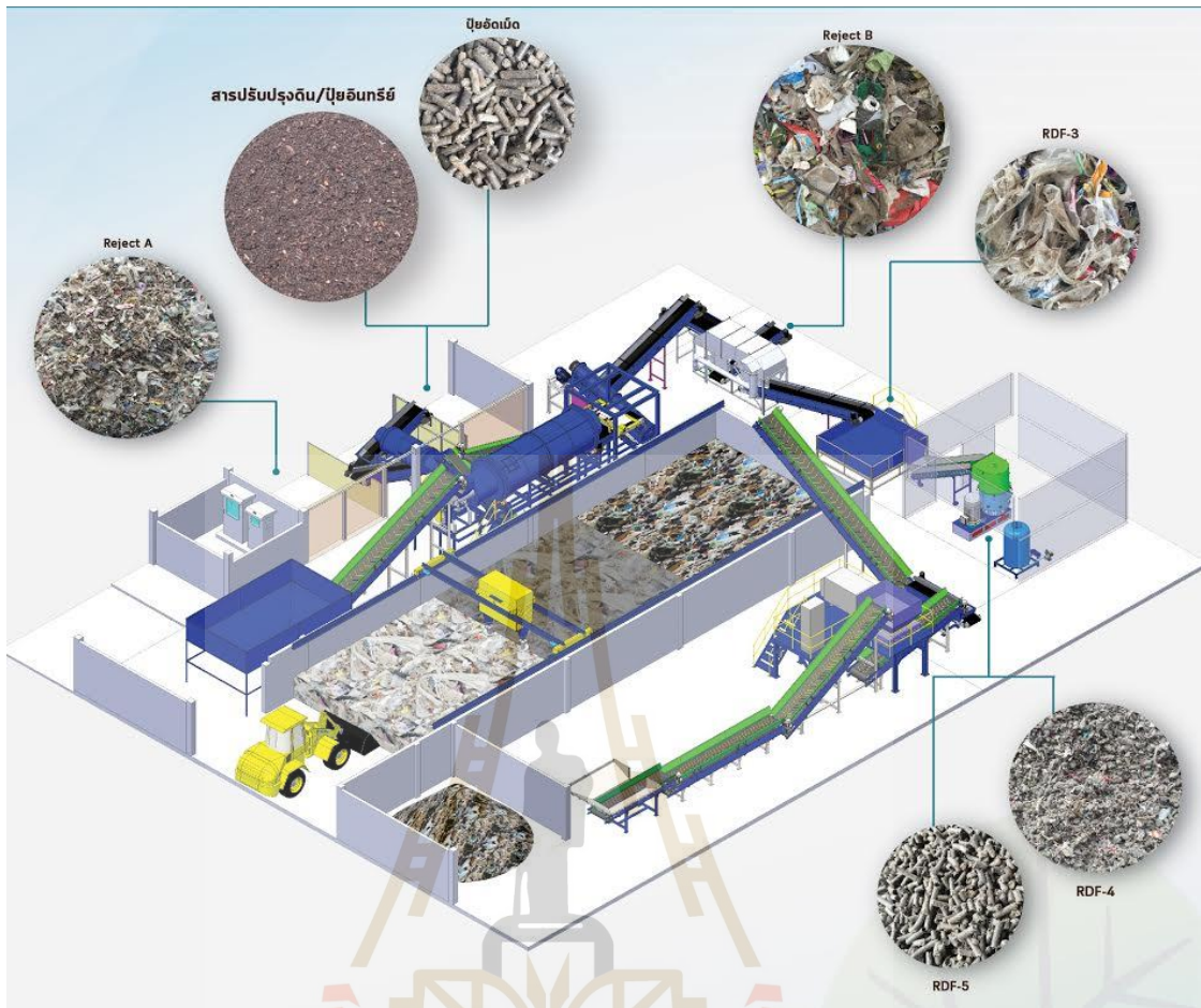
รูปที่ 2- 3 เทคโนโลยีการบำบัดขยะ SUT-MBT (ที่มา: มหาวิทยาลัยเทคโนโลยีสุรนารี)
