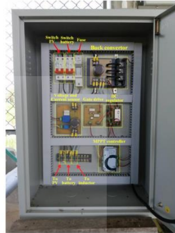
รูปที่ 19 ชุดทดสอบต้นแบบการตามรอยจุดกำลังสูงสุดสำหรับเซลล์แสงอาทิตย์แบบอิสระขนาด 2,400 W
