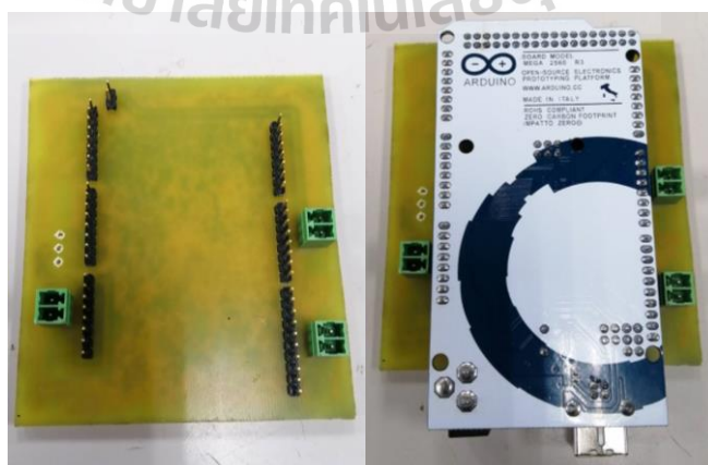
รูปที่ 5.5 Arduino shield ที่ใช้กับบอร์ดไมโครคอนโทรลเลอร์
