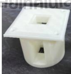
ภาพที่ 28 แท่นวาง Cuvette ที่ออกแบบขึ้นมาและพิมพ์ออกมาด้วยเครื่องพิมพ์สามมิติ โดยใช้วัสดุเป็นพลาสติก
