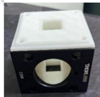
ภาพที่ 28 แท่นวาง Cuvette ที่ออกแบบขึ้นมาและพิมพ์ออกมาด้วยเครื่องพิมพ์สามมิติ โดยใช้วัสดุเป็นพลาสติก
