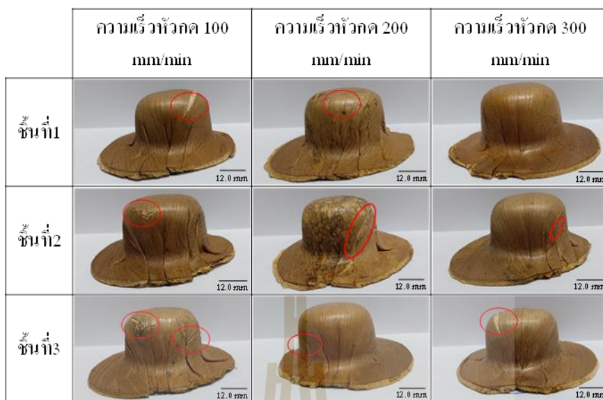
รูปที่ 5.12 ข้อบกพร่องของชิ้นงานที่บริเวณด้านข้างของชิ้นงานที่ความเร็วหัวกด 100 200 300 มิลลิเมตรต่อนาที
