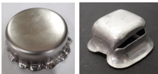
(a) รอยยับบนขอบ (b) รอยฉีกขาดบริเวณผนังหรือก้น
