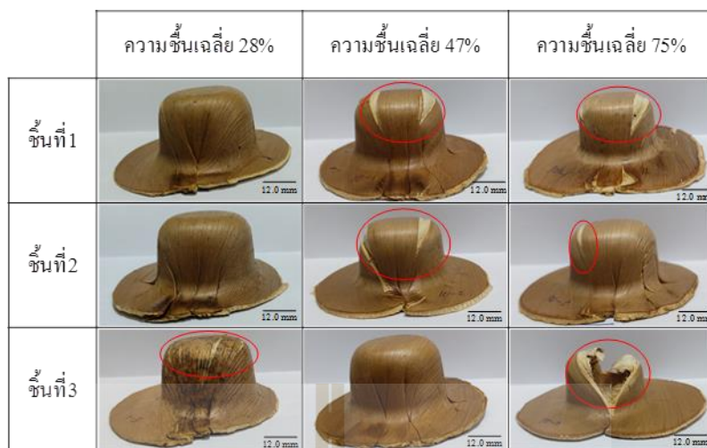
รูปที่ 5.7 ซ็อกบพร่องของชั้นงานที่บริเวณข้างล่างของชั้นงานที่ความชื้น 28% 47% 75%
