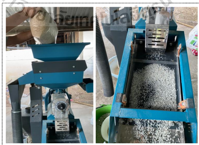
รูปที่ 3.24 การสีข้าวด้วยเครื่องสีข้าวและขัดขาว ยี่ห้อ MARTEC รุ่น 10
