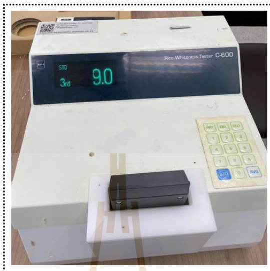
รูปที่ 3.18 เครื่องวัดความขาว Model : Kett C- 600, Kett Electronic Laboratory Corporation, Tokyo, Japan
