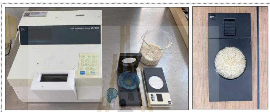
รูปที่ 3.27 วัดค่าดัชนีความขาวด้วยเครื่องวัดความขาว
