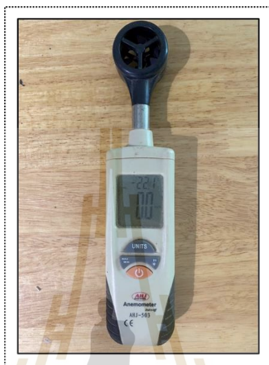
รูปที่ 3.16 เครื่องวัดความเร็วลมแบบดิจิทัล (Anemometer AHJ-503)
