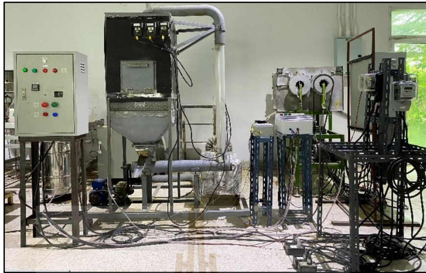
รูปที่ 3.5 เครื่องอบแห้งข้าวเปลือกแบบพาหะลมเสริมการทำงานด้วยอินฟราเรดที่พัฒนาขึ้น
