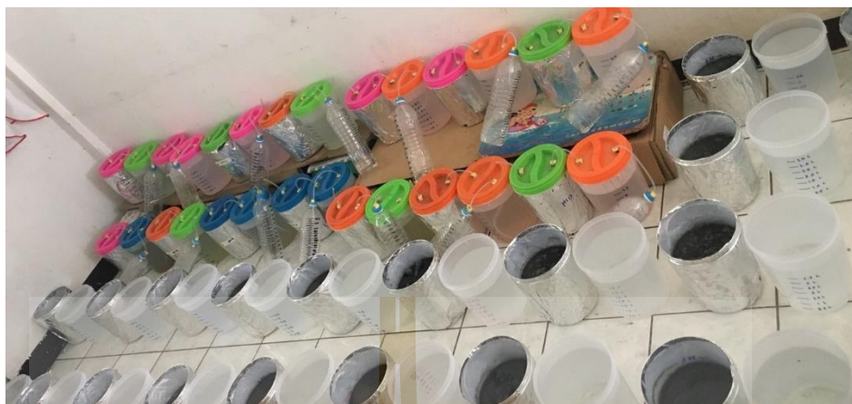
รูปที่ ก. 1 การทดลองแบบ Batch เพื่อศึกษา pH และ อุณหภูมิเพื่อเพิ่มกรดไขมันระเหยง่ายที่มีผลต่อการเกิดไบโอแก๊ส
