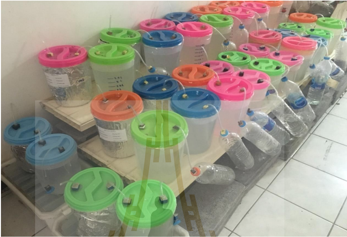
รูปที่ ง.1 ถังปฏิกิริยาแบบ Batch ที่ใช้ในการศึกษาเวลาในการทำปฏิกิริยาที่เหมาะสมต่อการเกิดไบโอแก๊ส
