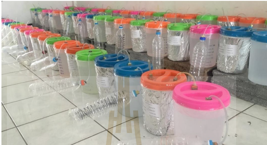
รูปที่ ข.1 การทดลองแบบ Batch เพื่อศึกษาสถานะที่เหมาะสมต่อการเกิดไบโอแก๊สเมื่อใช้เหล็ก ประจุศูนย์ 100 g/kg TVS
