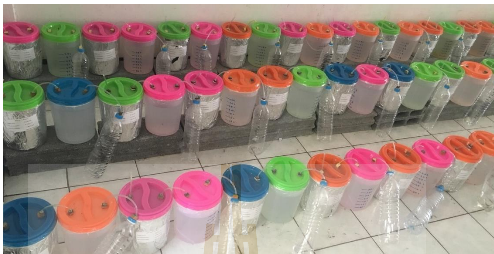
รูปที่ ค.1 ถึงปฏิบัติการแบบ Batch ที่ใช้ในการศึกษาปริมาณเหล็กประจุศูนย์ที่เหมาะสมต่อการเกิดไบโอแก๊ส
