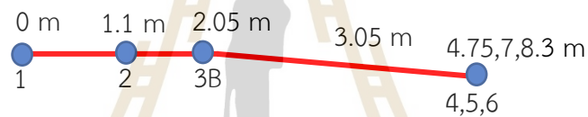
รูปที่ 4.11 ตำแหน่งการติดตั้ง RFID หมายเลข 3
