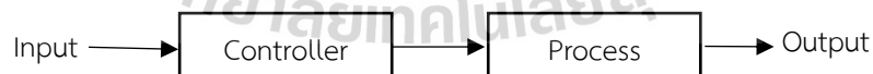
รูปที่ 2.8 บล็อกไดอะแกรมระบบควบคุมแบบเปิด
