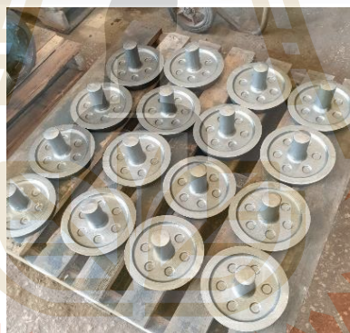
รูปที่ 2.13 แสดงรูปการหล่อขึ้นงานด้วยแบบหล่อทราย
