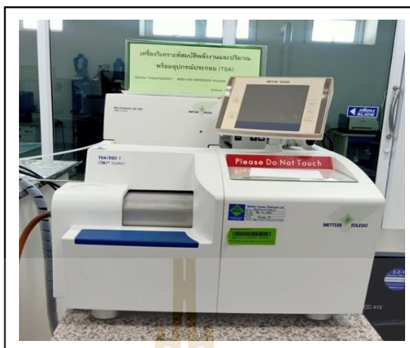
รูปที่ 3.9 เครื่อง Simultaneous Thermal Analysis ยี่ห้อ TGA/DSC1 รุ่น Mettler Toledo
