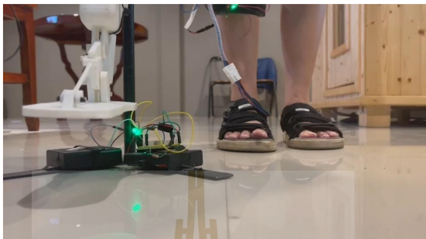
รูปที่ 4.12 ผลการควบคุมขาเทียมกล เท้าขวา และเท้าซ้ายท่าทาง Stand
