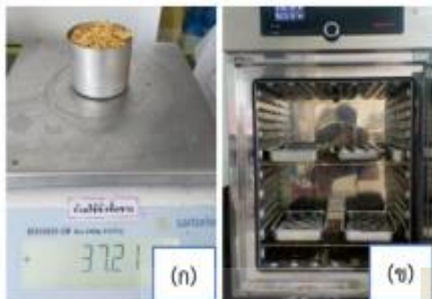
รูปที่ 1 ก) การชั่งน้ำหนักเพื่อหามวลเริ่มต้น ข) การอบตัวอย่างด้วยเครื่องอบแห้งมาตรฐาน
