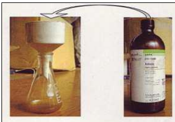
รูปที่ ก5 การล้างด้วยสารเคมี Anisole เพื่อกำจัดทาร์ออกจากกระดาษกรอง
