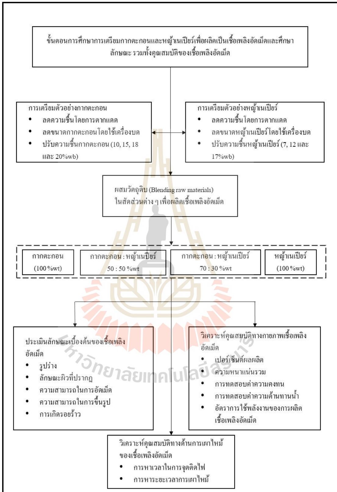
รูปที่ 3.2 ขั้นตอนการศึกษาการเตรียมกากตะกอนและหญ้าเนเปียร์เพื่อผลิตเป็นเชื้อเพลิงอัดเม็ด และศึกษาลักษณะ รวมทั้งคุณสมบัติของเชื้อเพลิงอัดเม็ด
