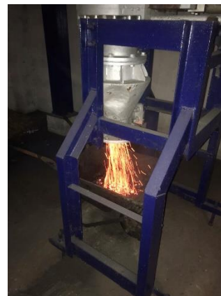
ฉ. เปิดวาล์วนำเชื้อแก๊สออกจากเตาผลิตแก๊สเชื้อเพลิง
