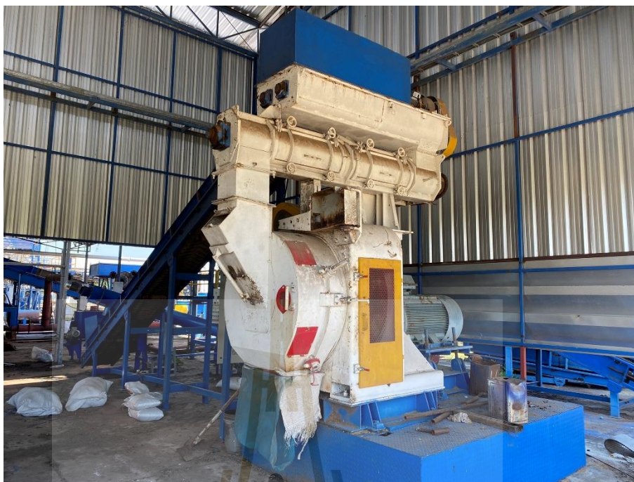
รูปที่ 3.6 เครื่องอัดเม็ดแบบแม่พิมพ์วงแหวน (Mill ring die pelletizer)
