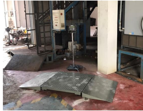
ง. ตาชั่งดิจิตอล ใช้วัด Fuel consumption และ Ash production
