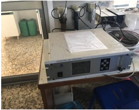
ค. Online portable gas analyzer ใช้วัดองค์ประกอบของแก๊ส
