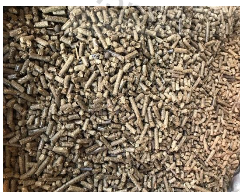
ค) SS/NG (50/50) หลังจากผลิตเชื้อเพลิงอัดเม็ด
