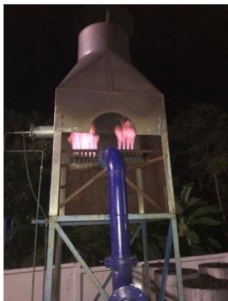
จ. ทดสอบการลุกไหม้ของแก๊สเชื้อเพลิง
