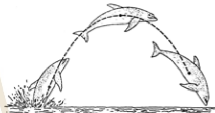
แผนภาพที่ 38 แนวการเคลื่อนที่ของจุดศูนย์กลางถ่วงของโลกาจะเป็นแนวพาราโบลา
