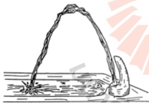
แผนภาพที่ 35 แนวการเคลื่อนที่ของโมเลกุลของน้ำจาก ก๊อก จะเคลื่อนเป็นแนวพาราโบลา
