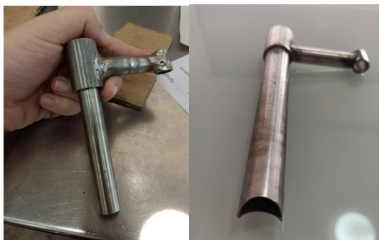
รูปที่ 3.17 รูปแบบหัวคว้านเมล็ดลำไยแบบปากตรง และปากกลม
