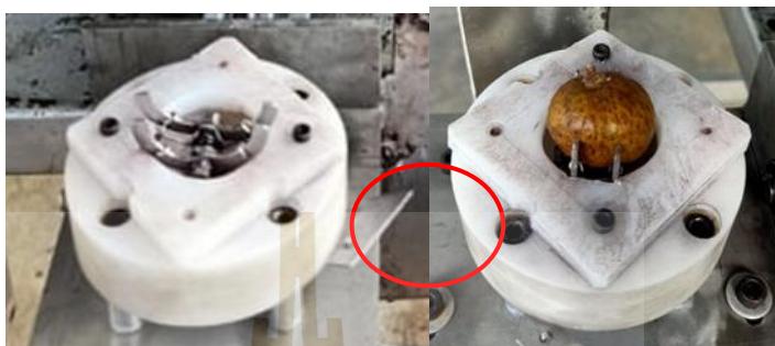
รูปที่ 3.11 สลักของกลไกการนำผลออกที่ติดตั้งกับเบ้ารองลำไย
