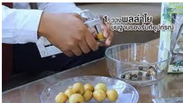
รูปที่ 2.3 อุปกรณ์คว้านเมล็ดลำไยที่ใช้มือบีบแบบสปริง ที่มา : ธนาธิป บุญถือ และคณะ (2559)
