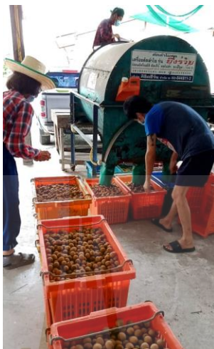
รูปที่ 3.22 การคัดขนาดลำไยโดย เครื่องคัดขนาดของ บริษัท ลิขิตชีวัน
