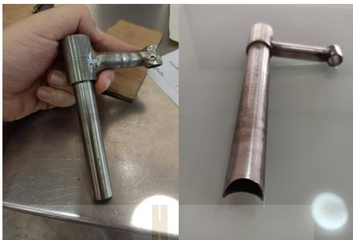
รูปที่ 4.9 รูปแบบหัวคว้านแบบปากตรง และแบบปากกลม
