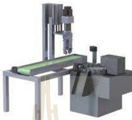
รูปที่ 2.24 เครื่องคว้านเมล็ดลำไยแบบอัตโนมัติ ที่มา : ศิระพงศ์ ลือชัย (2561)
