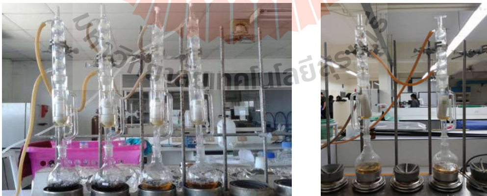
รูปที่ 3.5 การสกัดเหง้ามันสำปะหลัง (NCR) แบบต่อเนื่องด้วยน้ำและเอทานอล
