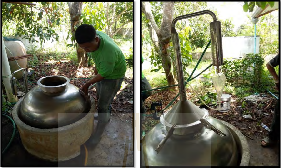
ภาพที่ 7 แสดงการเตรียมหม้อต้มกลั่นด้วยไอน้ำเพื่อสกัดน้ำมันวานหลง
