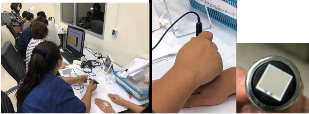
ภาพที่ 20 แสดงตัวอย่างการใช้ corneometer ในการวัดความชุ่มชื้นของผิวหนัง
