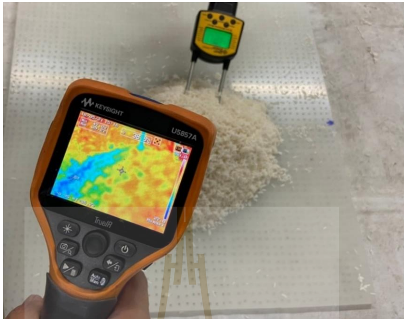
รูปที่ 4.12 ทำการวัดค่าความชื้นและอุณหภูมิข้าวหลังการทดสอบ
