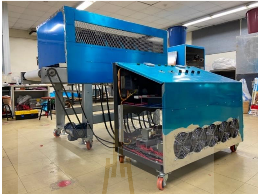
รูปที่ 3.17 ระบบสายพานลำเลียงที่ติดตั้งบนเครื่องลดความชื้นด้วยคลื่นไมโครเวฟ
