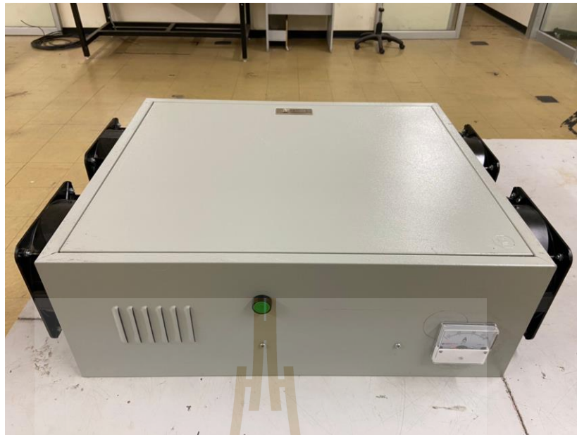
รูปที่ 3.39 เครื่องให้ความร้อนแบบเหนี่ยวนำภาคแหล่งจ่ายกำลังงานพร้อมชุดควบคุม
