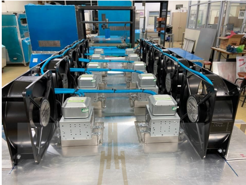
รูปที่ 3.13 ระยะการวางหัวแมกนีตรอนติดตั้งบนตู้ลดความชื้นด้วยคลื่นไมโครเวฟพร้อมระบบระบายความร้อน
