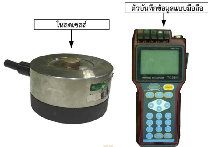
รูปที่ 4.7 เครื่องอ่านค่าแรงกดแบบดิจิทัล (Load Cell) และเครื่องอ่านและบันทึกข้อมูล (Data Logger) แบบมือถือ
