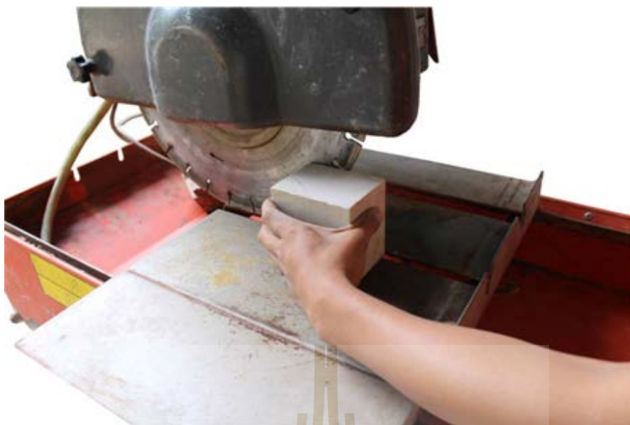
รูปที่ 3.2 ผิวนิวตันที่ได้จากเลื่อยตัดจากจากเครื่องตัดด้วยใบเลื่อย
