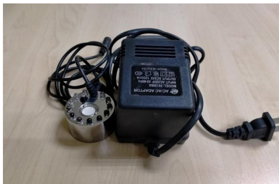
รูปที่ 1 เครื่องสร้างระลอกด้วยคลื่นอัลตราโซนิก หรือ เครื่องสร้างหมอกด้วยคลื่นอัลตราโซนิก ความถี่ 1.7 MHz
