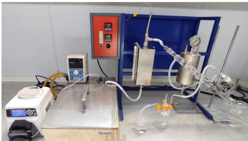
รูปที่ 3.3 ชุดทดสอบประสิทธิภาพของปฏิกิริยาดีไฮเดรชันแบบใช้ตัวเร่งของเอทานอลเพื่อผลิตไดเอทิลอีเทอร์
