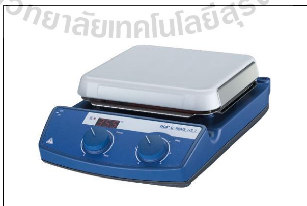
รูปที่ 3.9 เครื่อง Hot plate stirrers IKA รุ่น C-MAG HS 7
