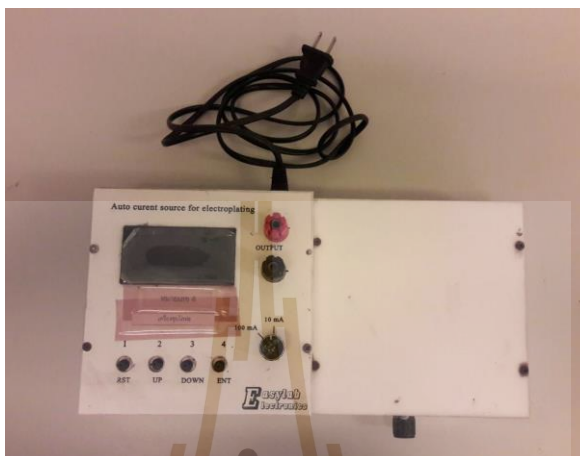
รูปที่ 3.8 เครื่องชุบโลหะด้วยไฟฟ้า
