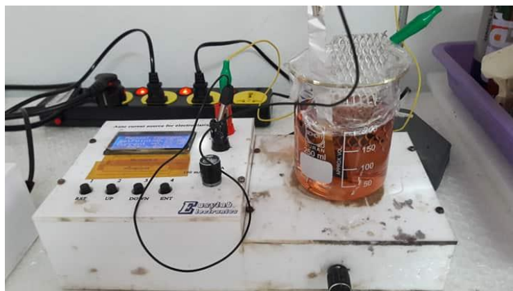
รูปที่ 3.31 การชุบโลหะทองคำด้วยไฟฟ้า
