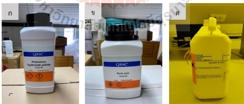
รูปที่ 3.23 สารเคมีสำหรับล้างสารไวแสง (ก) สารโพแทสเซียมไฮดรอกไซด์ (ข) สารบอริก และ (ค) สาร SU-8 developer
