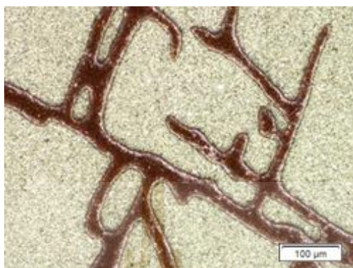
รูปที่ 3.30 แม่พิมพ์สารไวแสง AZP4620 บนแผ่นกราฟไฟต์
