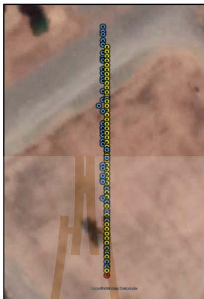
รูปที่ 4.9 แผนที่แสดงตำแหน่งจากการคำนวณและจากอุปกรณ์จีพีเอส มุม 0 องศา
