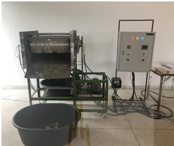
รูปที่ ง.9 อบแห้งกากมันสำปะหลังด้วยเครื่องอบแห้งแบบลูกกลิ้งคู่
