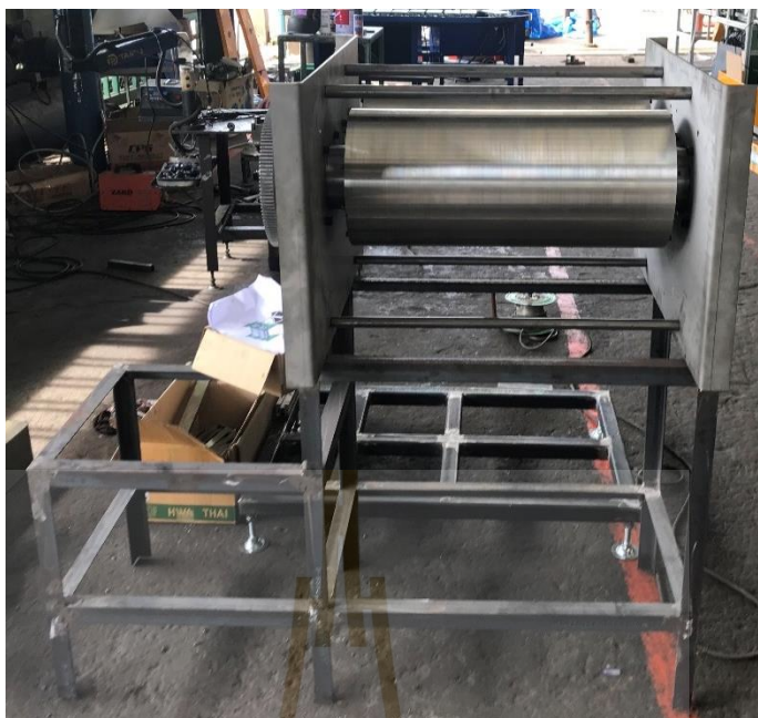
รูปที่ ง.3 สร้างเครื่องอบแห้งแบบลูกกลิ้งคู่
