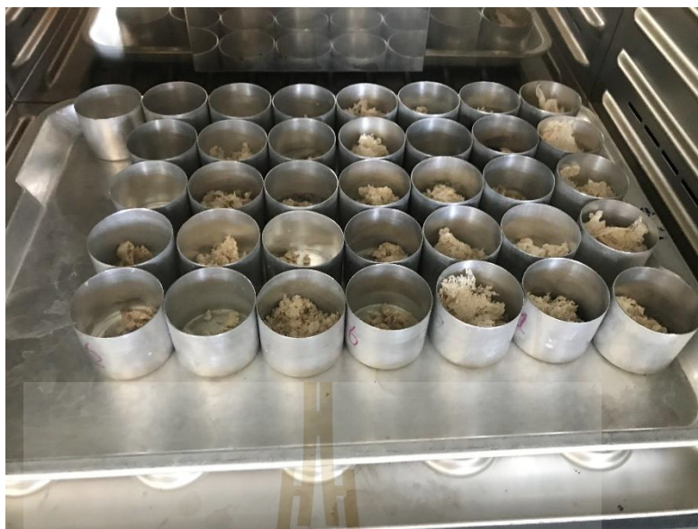
รูปที่ ง.11 หาคความชื้นกากมันสำปะหลังที่ได้ผ่านการอบแห้งจากเครื่องอบแห้งแบบลูกกลิ้งคู่
