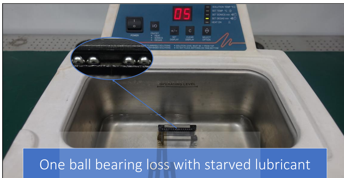
รูปที่ 3.10 สภาวะลูกปืนหาย 1 ลูกพร้อมสารหล่อลื่นเหลือน้อย (One ball bearing damage with starved loss)
