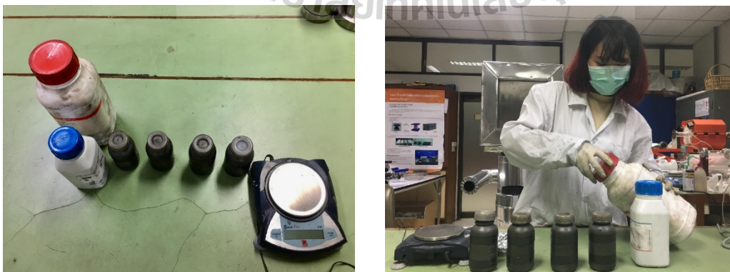
รูปที่ 20 การชั่งสาร Calcium carbonate ( \text{CaCO}_3 ) และสาร Manganese dioxide ( \text{MnO}_2 )
