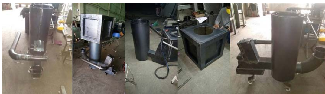
รูปที่ 27 โครงสร้างระบบต้นแบบเตาอุโมงค์ขนาดเล็กผลิตไฟฟ้าด้วยความร้อน
