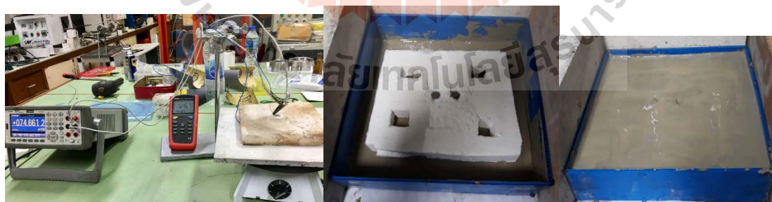
รูปที่ 25 การทดสอบไฟฟ้าเบื้องต้นและขึ้นรูปคอนกรีตบล็อกทนความร้อนพร้อมฝังโมดูลเทอร์
