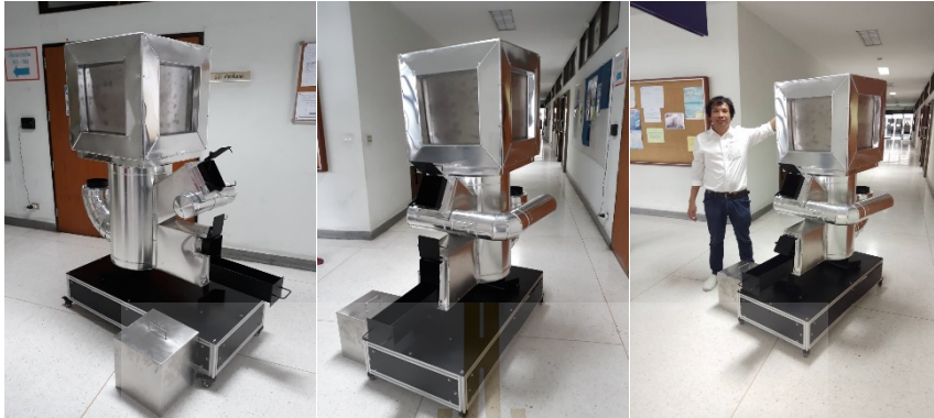
รูปที่ 30 ต้นแบบเตาอุณหภูมิขนาดเล็กผลิตไฟฟ้าด้วยความร้อนที่สร้างจริง ผลการวัด ค่าสมบัติทางเทอร์โมอิเล็กทริก ของวัสดุ \text{CaMnO}_3 ที่สังเคราะห์ขึ้นได้
