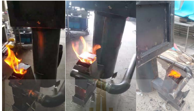
รูปที่ 28 การทดสอบเผาถ่านอัดแท่งชีวมวลกับระบบต้นแบบเตาอุโมงค์ขนาดเล็กผลิตไฟฟ้าด้วยความร้อนที่สร้างขึ้นจริง
