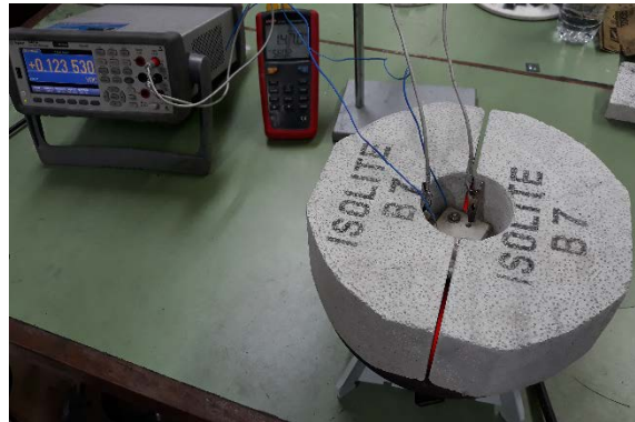
รูปที่ 36 การติดตั้งทดสอบสมบัติทางไฟฟ้าเบื้องต้นของวัสดุเทอร์โมอิเล็กทริก
