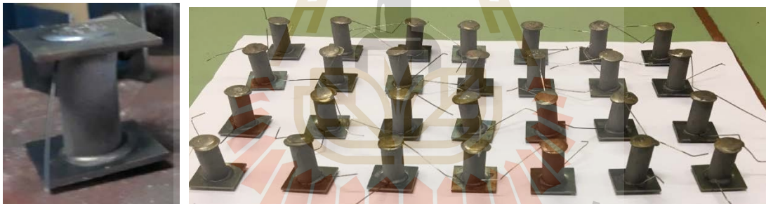
รูปที่ 44 การต่อขั้ววัสดุเทอร์โมอิเล็กทริกส์โมดูลเข้ากับขั้วสแตนเลส
