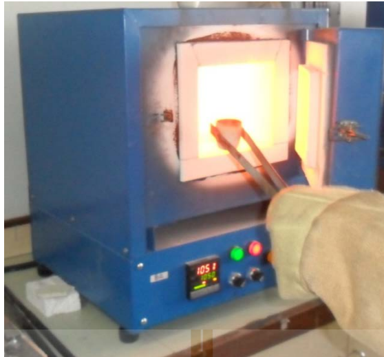
รูปที่ 43 นำวัสดุเทอร์โมอิเล็กทริกส์โมดูลเข้าเตาเผาไฟฟ้า ที่อุณหภูมิ 1050 °C
