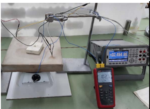
รูปที่ 36 การติดตั้งทดสอบสมบัติทางไฟฟ้าเบื้องต้นของวัสดุเทอร์โมอิเล็กทริก
