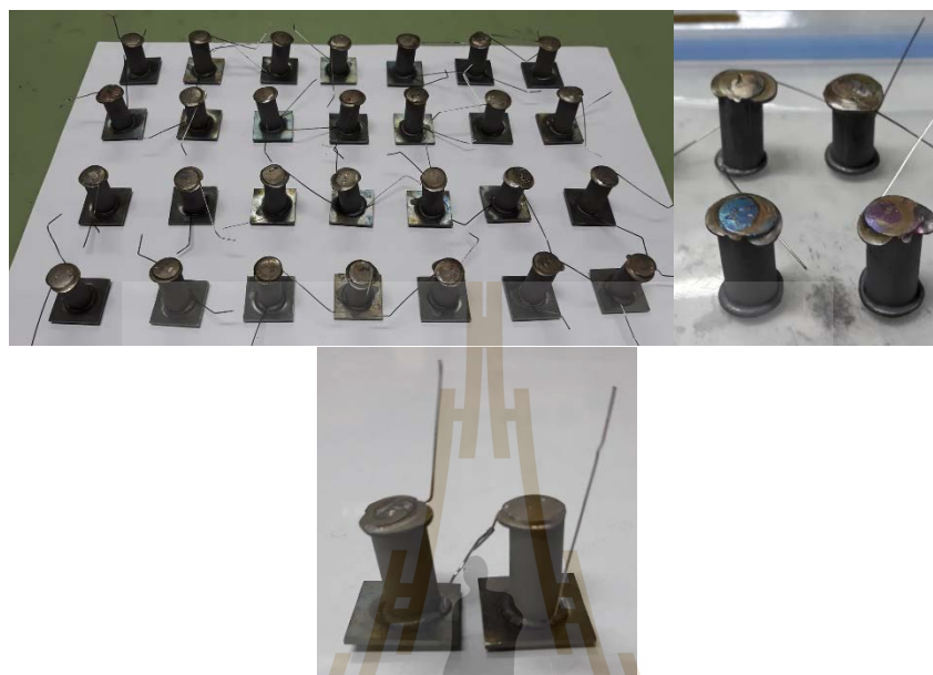
รูปที่ 24 การประกอบแท่งเทอร์โมอิเล็กทริกเข้ากับแผ่นขั้วไฟฟ้า
