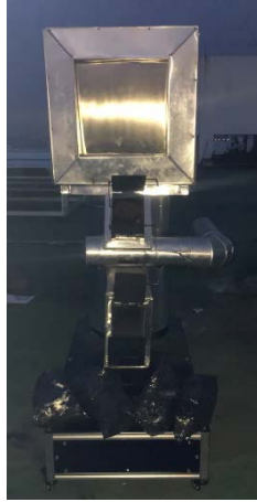
รูปที่ 51 ถ่านไม้อัดแท่งและเตาอุโมงค์ขนาดเล็กผลิตไฟฟ้าด้วยความร้อน
