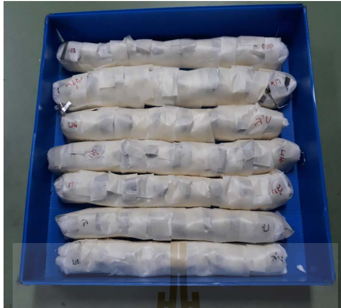
รูปที่ 45 หุ้มด้วยพลาสติกป้องกันน้ำเตรียมแบบหล่อคอนกรีต
