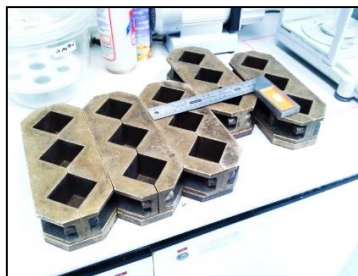
รูปที่ 3.2 แสดงแบบหล่อลูกบาศก์ขนาด 50x50x50
