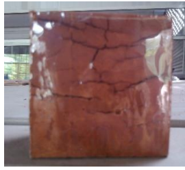
รูปที่ 4.8 แสดงรอยร้าวขนาดใหญ่ที่เกิดขึ้นบนชิ้นงานหลังผ่านการบ่มที่อุณหภูมิ 80 องศาเซลเซียส เป็นเวลา 7 วัน
