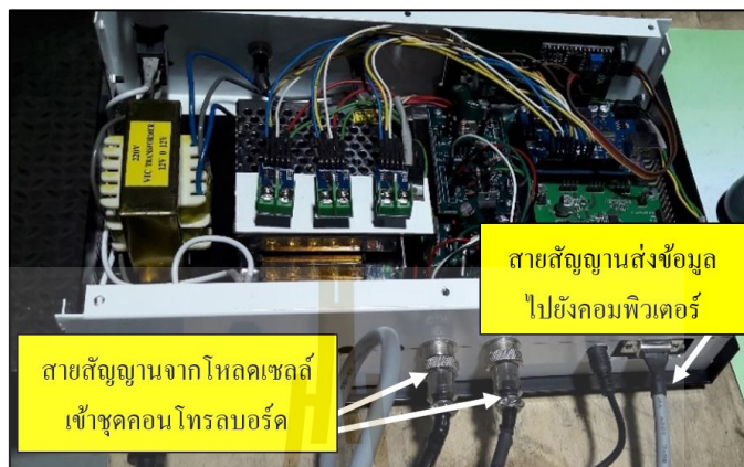
รูปที่ 3.13 การติดตั้งชุดคอนโทรลบอร์ด MATLAB Simulink เพื่อบันทึกค่าแรงกด
