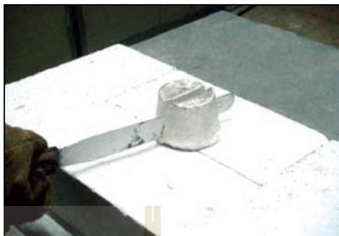
รูปที่ 2.5 สมบัติของแท่งอะลูมิเนียมกึ่งของแข็งที่ตัดด้วยมือ โดยใช้แรงเพียงเล็กน้อยก็ขึ้นรูปได้ (เจษฎา วรรณสินธุ์, 2552)
