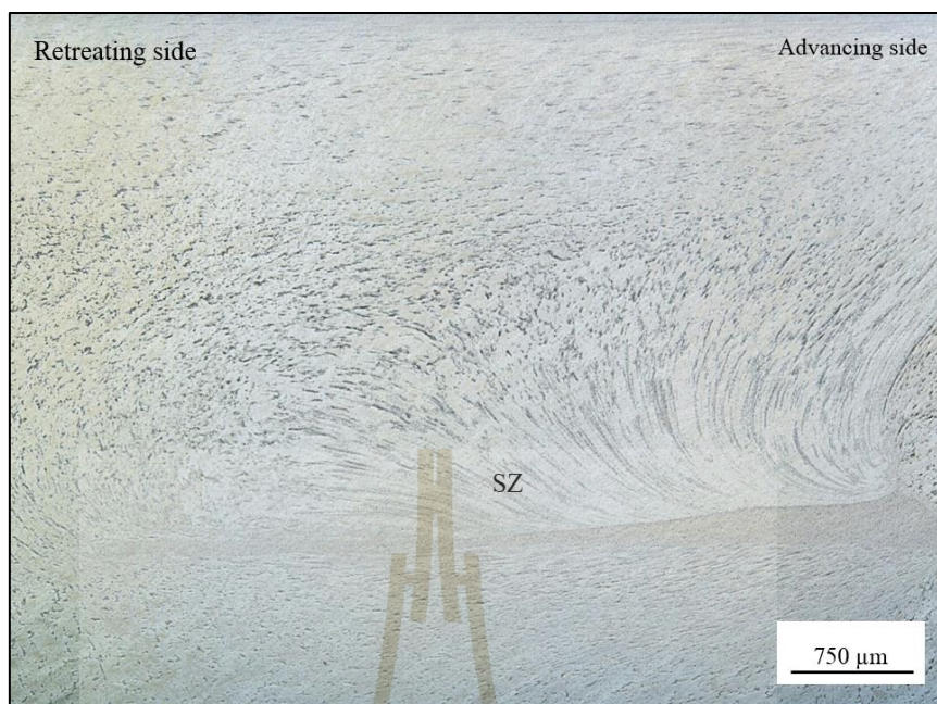
รูปที่ 4.35 โครงสร้างจุลภาคบริเวณพื้นที่ถูกกวนด้วยเครื่องมือเชื่อมที่อัตราส่วนความโตบ่า เครื่องมือกวนต่อหัวกวน (D/d) เท่ากับ 3 เท่า บ่ากวนขนาด 15 มิลลิเมตร หัวกวนขนาด 5 มิลลิเมตร ของรูปทรงหัวกวนแบบทรงกระบอกเรียบ ที่ความเร็วรอบในการหมุนกวน 790 รอบต่อนาที ความเร็วในการเดินเชื่อม 22 มิลลิเมตรต่อนาที
