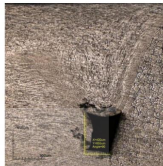
รูปที่ 10 ลักษณะจุดบกพร่อง (Void) ที่เกิดในรอยเชื่อม
