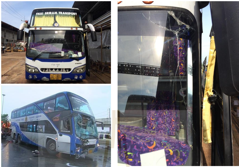
รูปที่ 2.4 กระจกหน้ารถทัวร์ที่แตกจากโรงงาน
