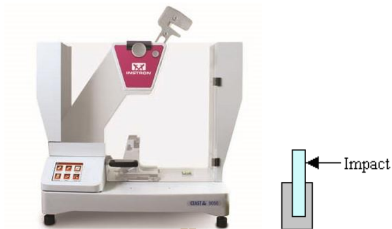
รูปที่ 3.13 เครื่องทดสอบแรงกระแทก และลักษณะการจับชิ้นงานทดสอบ
