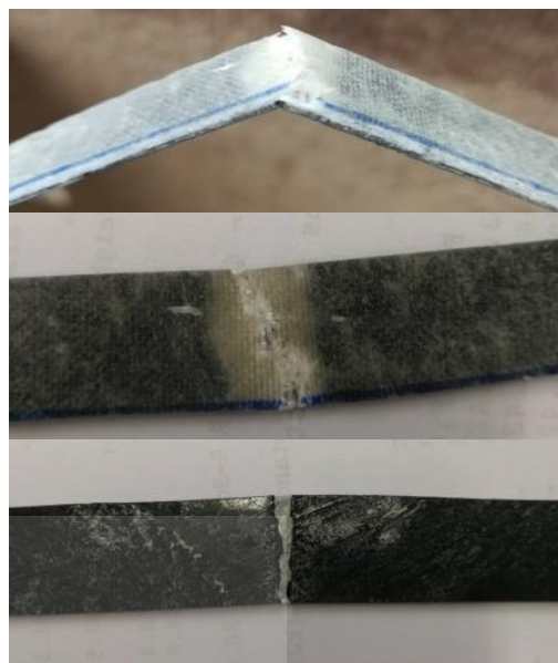
ข) ขนาดอนุภาค 108 ไมโครเมตร น้ำหนัก 450 กรัมต่อตารางเมตร ค่าต้านทานแรงดึงอ เท่ากับ 35.491 MPa
