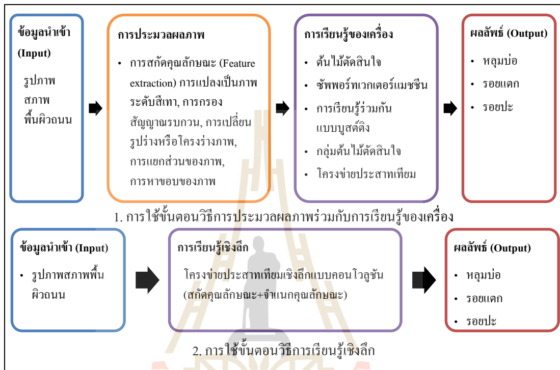
รูปที่ 2.9 การใช้ขั้นตอนวิธีการประมวลผลภาพร่วมกับการเรียนรู้ของเครื่องและการเรียนรู้เชิงลึก
