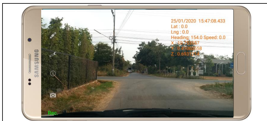
รูปที่ 3.3 หน้าจอบันทึกข้อมูลภาพวิดีโอและค่าอัตราเร่งของแรงสั่นสะเทือน
