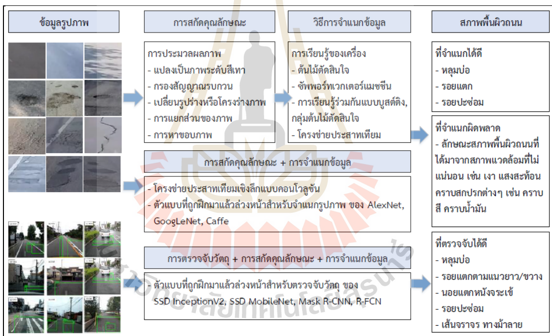
รูปที่ 2.24 การตรวจจับสภาพพื้นผิวถนนที่ผิดปกติด้วยวิธีการพื้นฐานจากการมองเห็น
