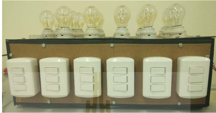
รูปที่ 6.6 ชุดโหลดหลอดไฟฟ้ากระแสตรง (โหลด R_L )
