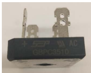
รูปที่ 6.5 วงจรเรียงกระแสหนึ่งเฟสแบบบริดจ์ รุ่น GBPPC3510
