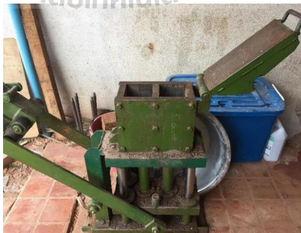
รูปที่ 3.4 เครื่องอัดบล็อกประสานด้วยแรงคน
